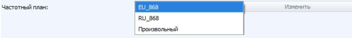
В частотном плане устройства по умолчанию активны только те каналы, на которых устройство отправляет запросы на присоединение к сети (Join-каналы). Остальные каналы, которые устройство должно использовать могут быть переданы сетевым LoRaWAN сервером во время процедуры присоединения устройства к сети.
