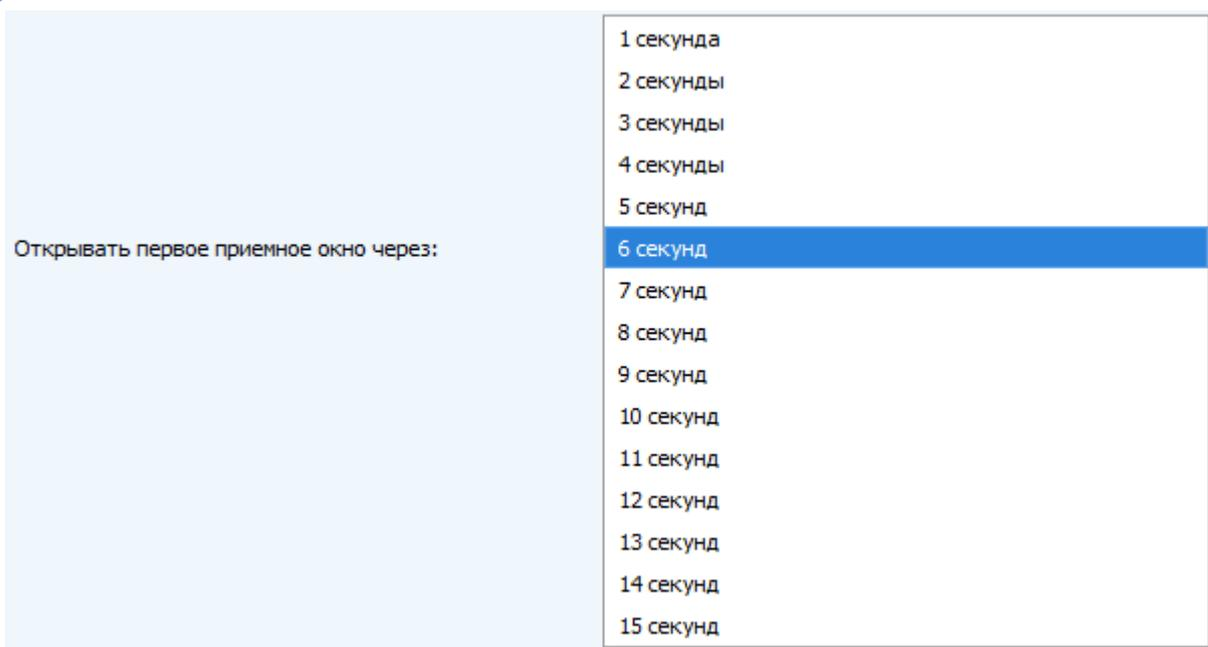
**Задержка 1 на подтверждение присоединения к сети** (не отображается в режиме «Простой») – задаёт время, через которое устройство откроет первое приёмное окно для получения подтверждения присоединения к сети LoRaWAN при работе в режиме присоединения ОТАА. Второе окно всегда открывается через 1 секунду после первого.
