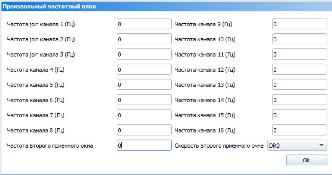
Данный частотный план позволяет задать до 16 каналов, а также частоту и скорость второго приёмного окна.
