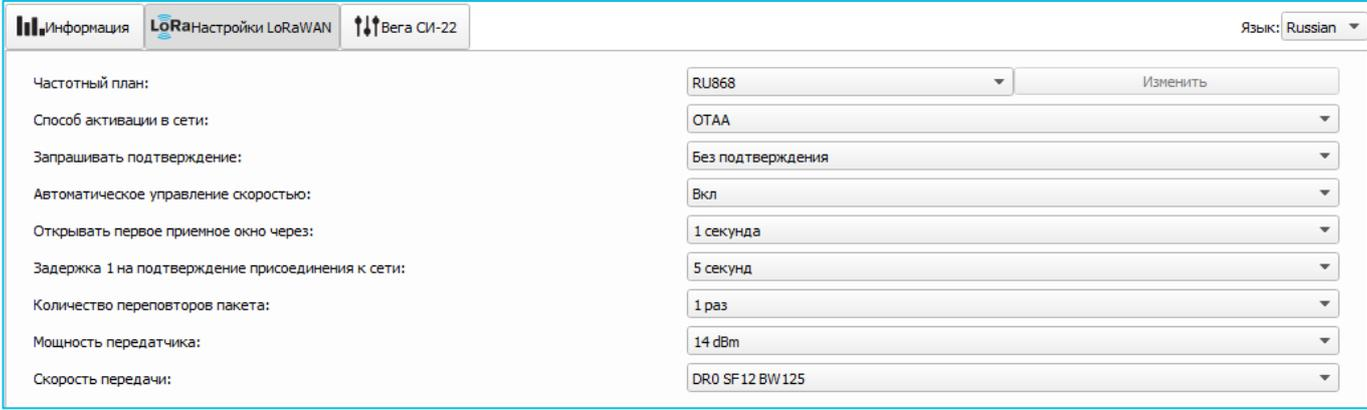
**Частотный план** – позволяет выбрать один из частотных планов, имеющих на устройстве или задать *произвольный* частотный план. Произвольный частотный план функционирует на базе частотного плана EU-868.
